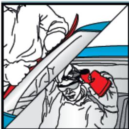
13. Bringen Sie alle Innenausstattungen, Leisten und sonstige zuvor entfernte Zubehörteile wieder an. Entfernen Sie die Schutzvorrichtungen des Fahrzeugs.
