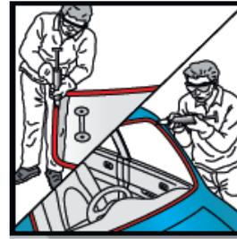
11. Tragen Sie eine dreieckige Klebstoffraupe entweder auf die Scheibe oder auf den Fahrzeugrahmen auf. Nutzen Sie hierfür die speziell zugeschnittenen Düsen, die Ihnen mitgeliefert worden sind.
